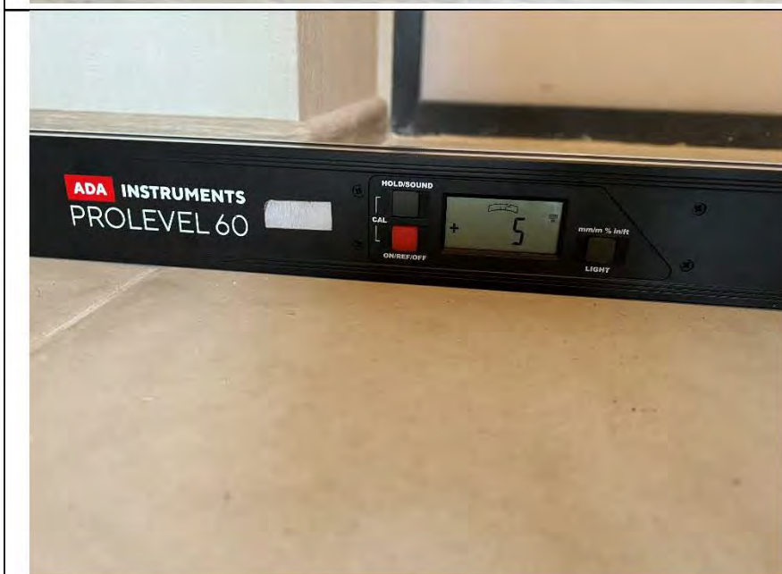
Фото №14. Измерение уровня напольного покрытия в коридоре.
