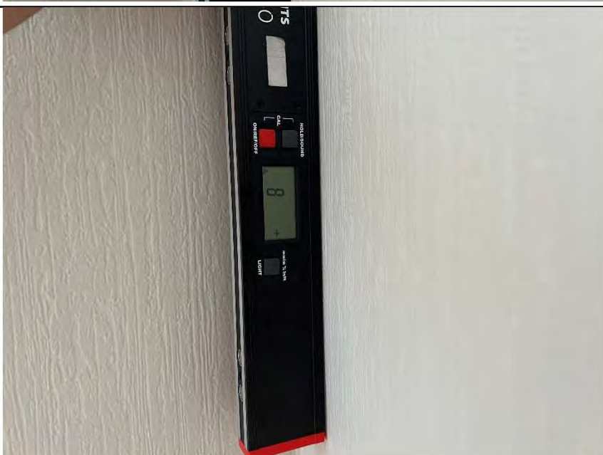
Фото №6. Измерение уровня стен в кухне-гостиной.
