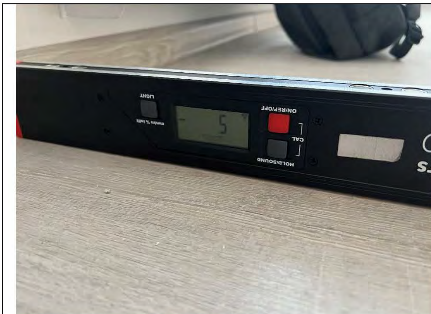
Фото №13. Измерение уровня напольного покрытия в кухне-гостиной.
